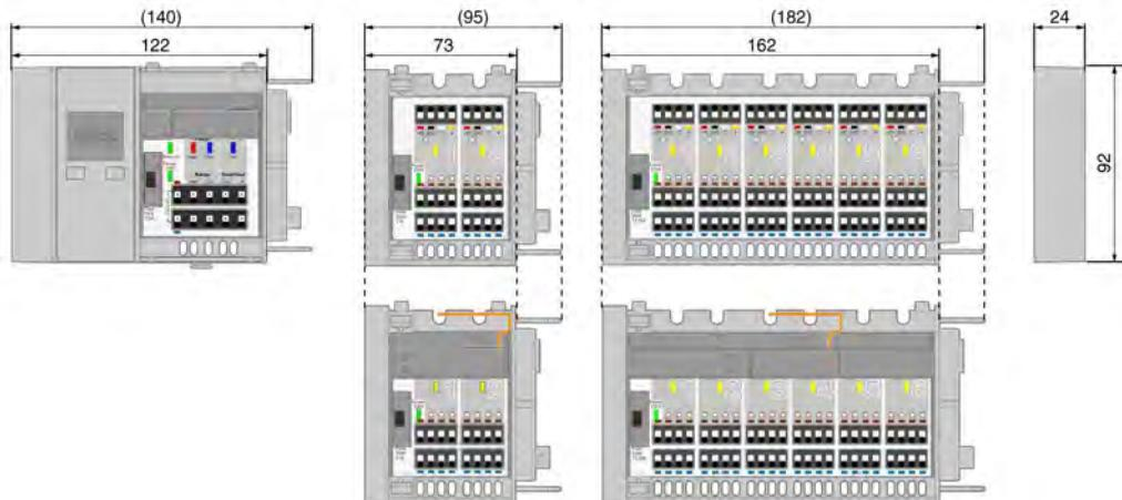
Figure 3 : Encombrement des modules CosiTherm®
