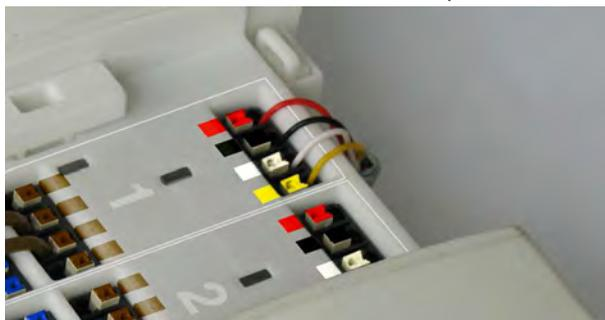
2. Faire passer le câble à l'arrière du module dans le guide (2). Fixer le câble de la commande thermique et du thermostat à l'aide du cavalier (1).
